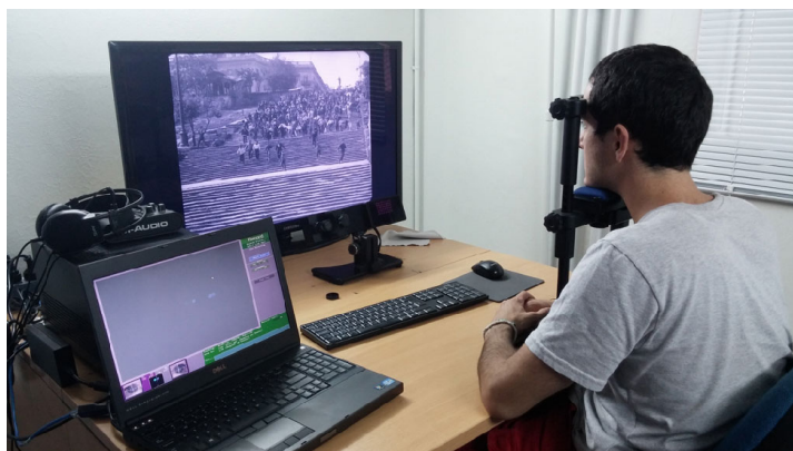
Fig. 1. Equipo de seguimiento ocular EyeLink 1000 Plus del Laboratorio de Arte Electrónico e Inteligencia Artificial, UNTREF.
