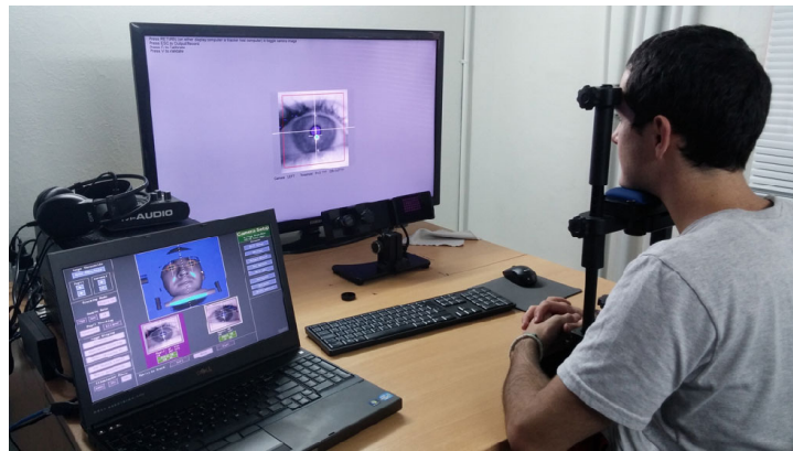
Fig. 2. Ajuste de la posición del participante y del EyeLink 1000.
